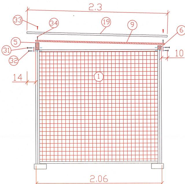
9. Dachblende Nr. 12 (braunes U-Profil) aufschieben – zuvor die Schutzfolie abziehen.
